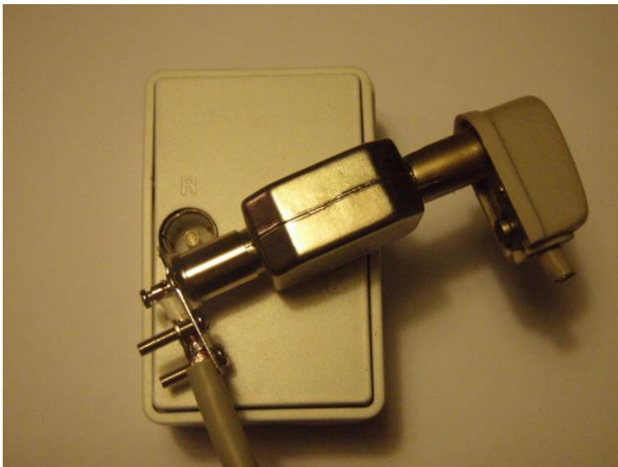
Eksempel på dårlig TV splitter (tydelig sprække mellem de 2 halvdele), med 2 plastik vinkelstik
