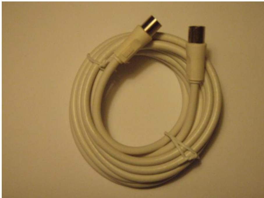
Fabriksmonteret snøreledning, med dobbelt-skærmet kabel og støbte stik.
